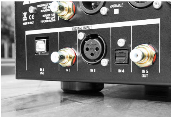
Gut gewappnet – die Norma-HS-Geräte stellen alle wichtigen digitalen Anschlussarten zur Verfügung, die jeweils bis 24 Bit/192 kHz arbeiten: 1 x USB-Typ-B (asynchron), 2 x S/PDIF-Cinch, 1 x AES/EBU, 1 x Toslink
