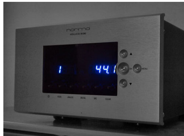
Die Darstellung von Zahlen bereitet dem Sieben-Segment-Display dagegen naturgemäß keine Probleme
