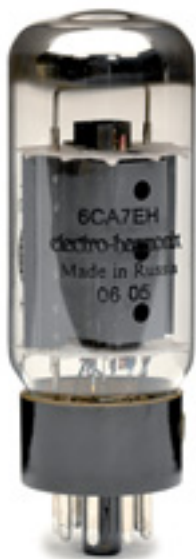
Früher auch schon andernorts eine gute Wahl: die 6CA7, hier von EH
