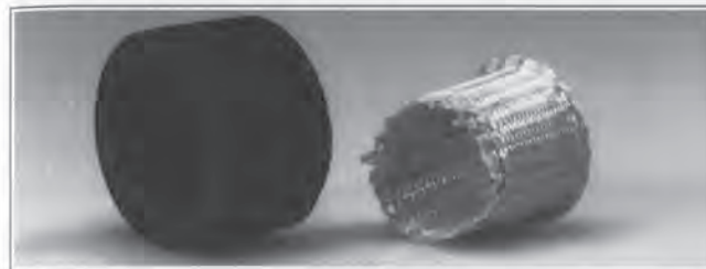
Damit wird die erstaunliche Wirkung erzielt: leitfähiger Ring und Aramidgewebe
