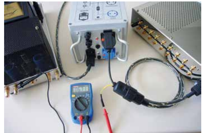
Messaufbau zur Einstellung der Kompensation. Hier wird die Vorstufe zur Endstufe hin eingestellt.
