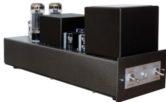
Die Monoendstufen JA15 – die auf Basis einer Push-Pull-Schaltung im Ultralinearbetrieb arbeiten und bis circa 20 Watt im Class-A-Bereich laufen – sind ein schönes Beispiel dafür: Lediglich drei Röhren sind in die Signalverstärkung involviert. Eine ECC83 als Eingangsrohre und Phasenteiler sowie zwei 6CA7 für die Leistungsverstärkung.
