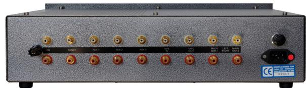
Eingängen gibt es einen Tape-Schleifen-Ausgang sowie zwei Paar Vorstufenausgänge zum Anschluss von maximal zwei Stereo- oder vier Mono-Endstufen. Ansonsten fällt neben dem Netzanschluss noch eine Erdungsklemme auf. Der Anschluss an die zentrale Erdung der Vorstufe kann in Verbindung mit einer Phonovorstufe nützlich sein.
