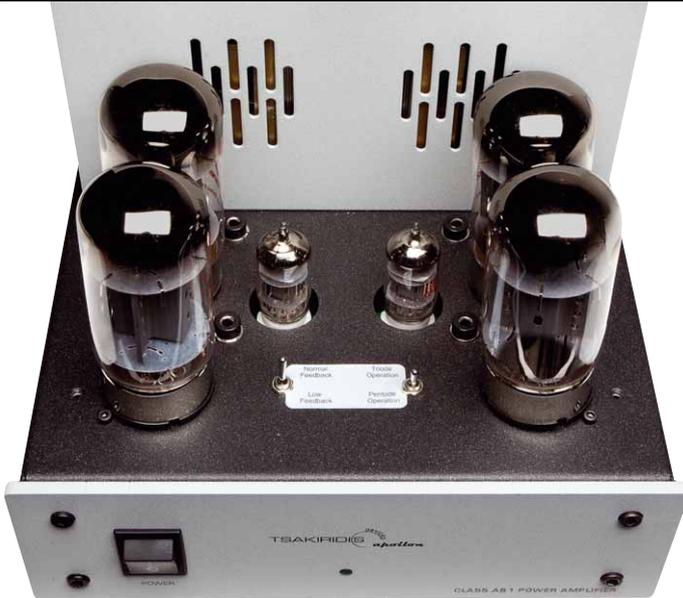
Vier dicke Endröhren, eine schaltbare Gegenkopplung und der Wahlschalter für den Pentoden/Triodenbetrieb prägen das Bild der Front
