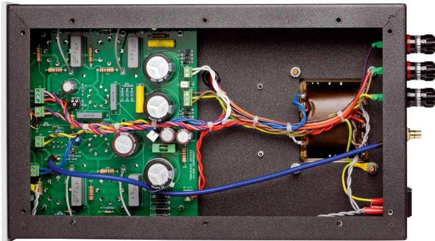
*Außer einem auch hier sehr sauberen Aufbau kann man im Inneren der Endstufe nicht erkennen – die klangentscheidenden Elemente wie Trafos und Röhren sitzen traditionell auf der Oberseite*
