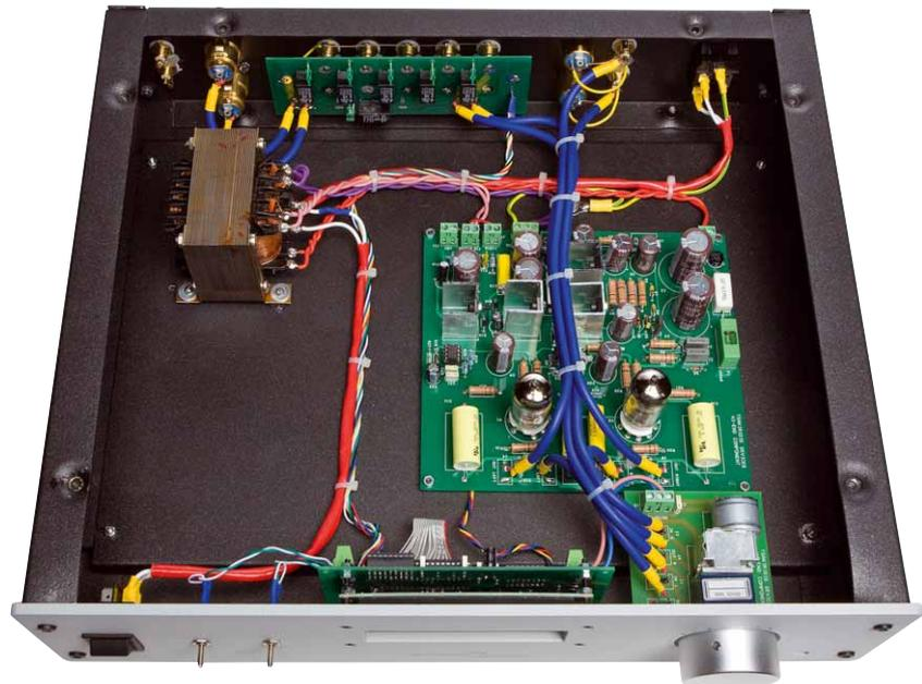
*Recht übersichtlich geht es im Inneren der Vorstufe zu – die Schaltung ist sauber auf doppelseitige Platinen aufgebaut, die Kanalumschaltung erfolgt über Relais*
