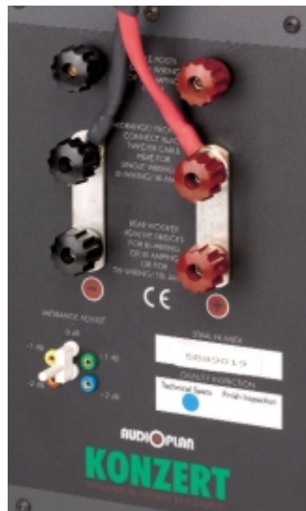
Anschlussoptionen: Von Single- bis Tri-Wiring reichen die Möglichkeiten. Tipp: Bei Bi-Wiring rückwärtigen Bass und Tiefmitteltöner auftrennen
