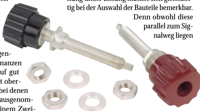
Massiv versilbert: Die Klemmen der Terminals haben durch die Bildung von Silberoxid immer guten Kontakt. Nicht zu fest andrehen!
