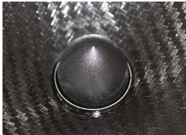
Anstelle einer Staubschutzkalotte hat das Chassis einen Phaseplug aus Kunststoff. Damit kann die sonst übliche Staubschutzkalotte im Zentrum der Membran entfallen. Staubschutzkalotten stehen im Verdacht, für unerwünschte Kompressionseffekte der zwischen dem Polkern des Magneten und eben der Staubschutzkalotte eingeschlossenen Luft verantwortlich zu sein. Daneben soll ein Phaseplug das Abstrahlverhalten eines Chassis verbessern.
